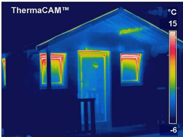
**Außenmessung:** Haus gut gedämmt, Türrahmen oben schlecht gedämmt, großer Wärmeverlust durch gekippte Fenster
