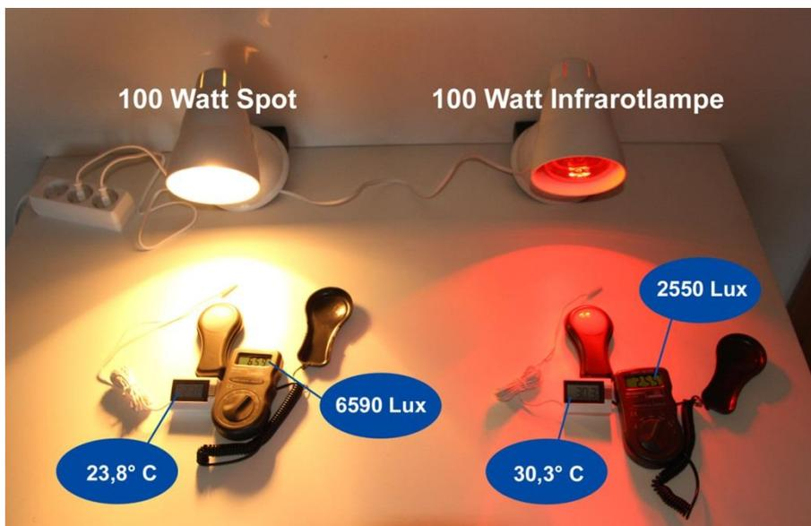
**Wichtig:** Die Lampen nur 1x einschalten und dann die Messungen durchführen, nach der Messung gleich ausschalten und vor dem Wegräumen abkühlen lassen. Durch oftmaliges Ein/Aus-Schalten bzw. Erschütterungen im heißen Zustand gehen die Lampen früher kaputt!
