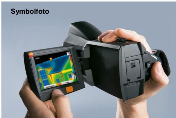
Eine Wärmebildkamera (Thermografiekamera) empfängt mittlere Infrarotstrahlung (für den Menschen unsichtbare Wärmestrahlung) und ist daher für die Messung und bildliche Darstellung von Temperaturen im Umgebungstemperaturbereich geeignet. Bei der Thermografie werden Temperaturverteilungen auf Flächen und Gegenständen erfasst und dargestellt.
