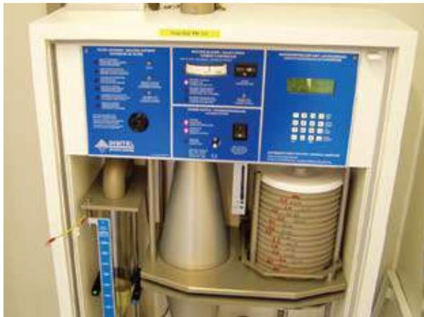
Abb. 85: Das Innere eines High-Volume-Samplers
