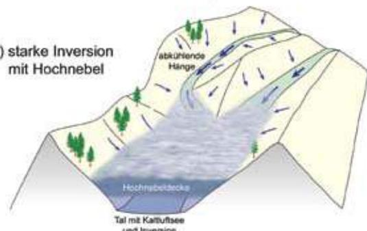
Abb. 35: Schema eines nächtlichen Lokalwindsystems
