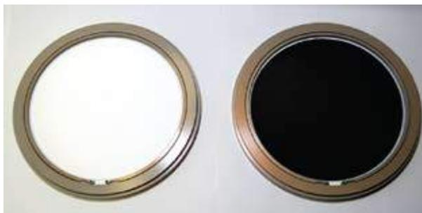
Abb. 86: Staubfilter vor Messbeginn (links) und nach einem Tag (rechts)
