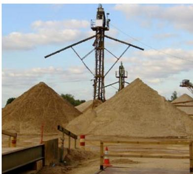
Abb. 17: Der Witterung ausgesetzte, offene Lagerung von Gesteinstäuben
