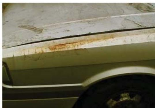
Abb 3: Rostschäden
