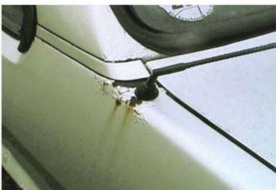
Abb. 4: Rostschäden
