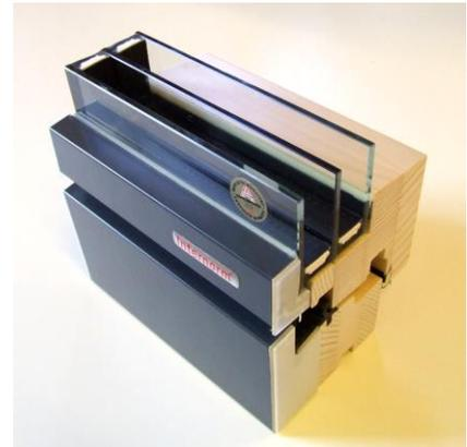
**U-Wert der Verglasung ( $U_g$ ):** Er hat den größten Einfluss auf den Gesamt-U-Wert des Fensters. Der  $U_g$ -Wert ist abhängig von der Scheibenzahl, der Gasfüllung und der Anzahl der Beschichtungen. Ein guter  $U_g$  liegt bei etwa  $0,7$  bis  $0,5 \text{ W/m}^2\text{K}$ .
