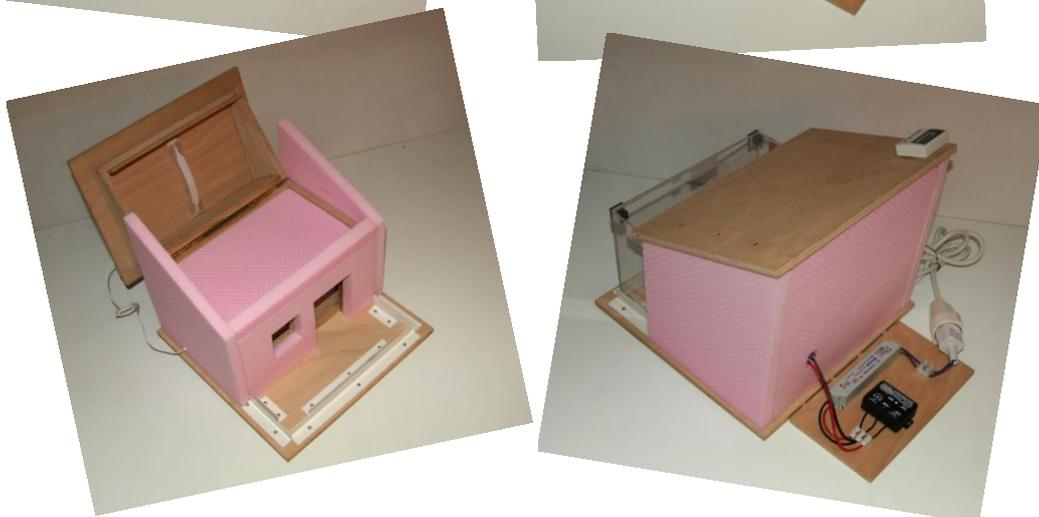
Vorder- und Rückansicht des Muster-Hauses mit Wanddämmung
