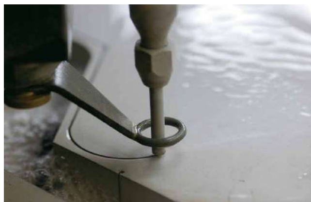
Abb. 3: Schneiden von Metallblech mit einem Wasserstrahl; Bystronic/Wikipedia
