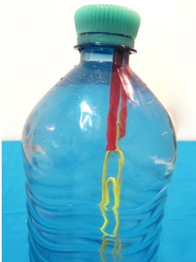
Abb. 2: Beim Zusammendrücken der Flasche kann man gut erkennen, dass die Luft im Strohhalm komprimiert wird.
