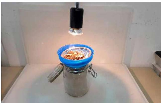
Abb. 3: einfacher Aufbau eines Berleseapparates; UBZ
