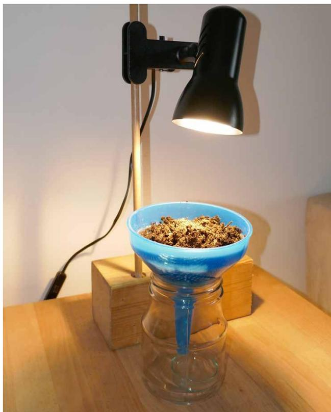
Abb. 2: einfacher Aufbau einer Berleseapparatur; UBZ
