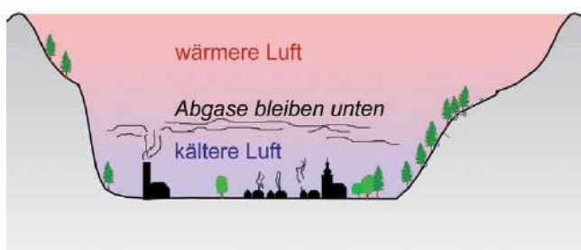
Abb. 4: Schematische Darstellung einer Inversion. M. Krobath
