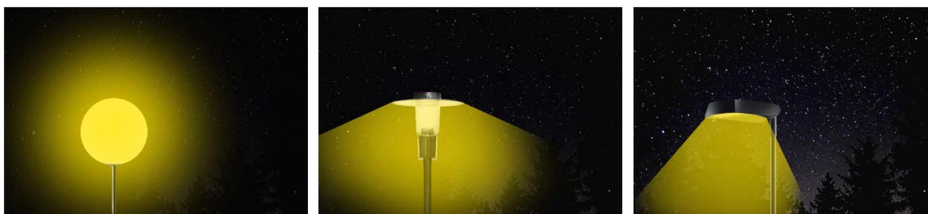
Abb. 17: Arten der Außenbeleuchtung: Kugelleuchte, abgeschirmte Leuchten (Standard-Straßenleuchten), Full-Cut-Off-Leuchten
