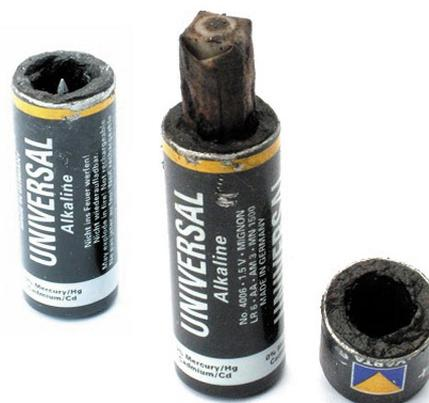
Abb. 2: Geöffnete Alkali-Mangan-Batterie, wikipedia
