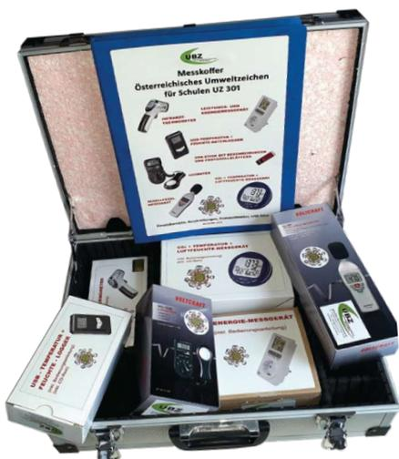
Der neue Praxiskoffer des UBZ beinhaltet Messgeräte, mit denen Luftfeuchtigkeit, Temperatur, Beleuchtungsstärke, Energieverbrauch, CO<sub>2</sub>-Gehalt sowie der Schalldruckpegel einfach ermittelt werden können. Die Geräte wurden so gewählt, dass sie auch von SchülerInnen bedient werden können; manche Geräte sind allerdings erst für SchülerInnen ab der 5. Schulstufe geeignet.
