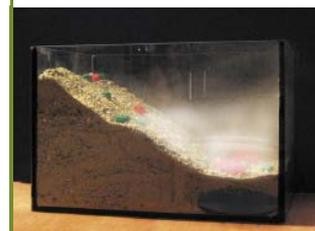
*Das Inversionsmodell - eines der für das Hauptschul-Coaching entwickelten Luftexperimente.*
