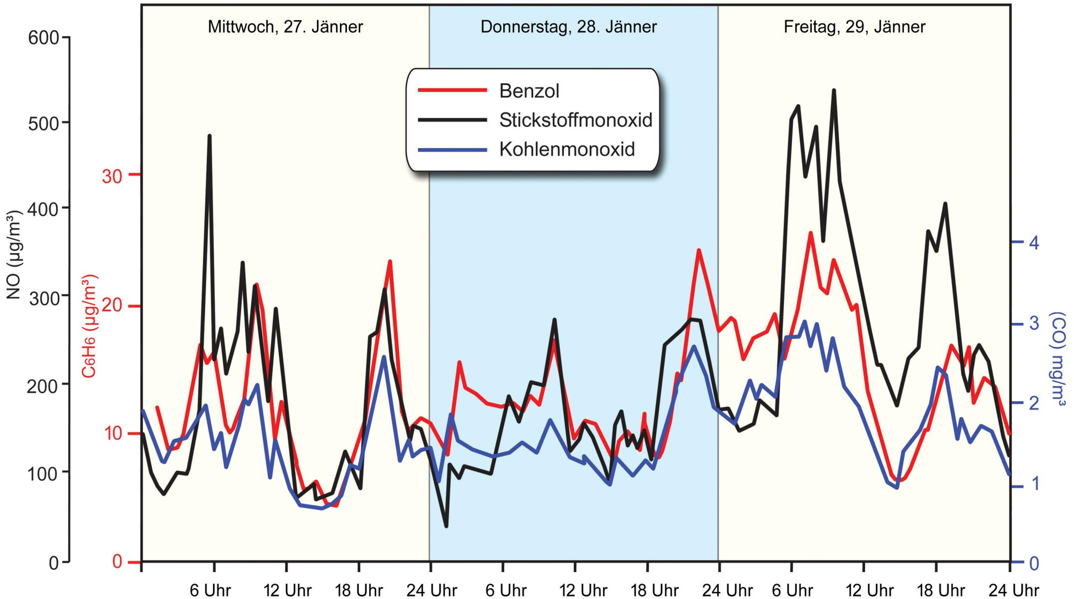
Abb. 76: Verlauf von Benzol (C<sub>6</sub>H<sub>6</sub>), Stickstoffmonoxid (NO) und Kohlenstoffmonoxid (CO) an der Station Graz-Don Bosco vom 27.1. bis 29.1.2010
