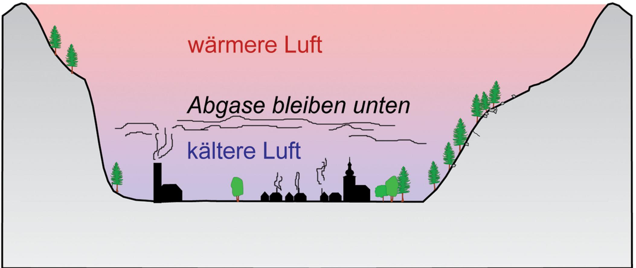
Abb. 31: Schematische Darstellung einer Bodeninversion
