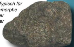
Abb. 5: Beispiel für einen Gneis. Gneise sind mittel- bis grobkörnige Metamorphite, die sich vom Glimmerschiefer v.a. durch ihren hohen Anteil an Feldspat unterscheiden.
