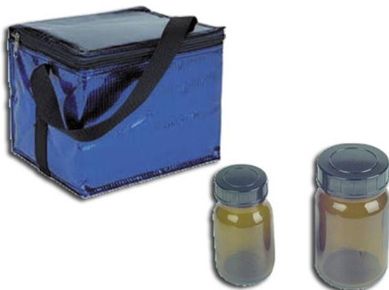
Abb. 4: Materialien für die Probenahme
