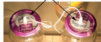
Temperaturfühler durch Löcher in Deckeln stecken
