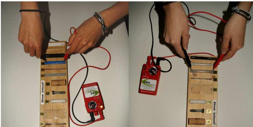
5. Dieser letzte Versuch sollte von LehrerInnen demonstriert werden! Mit einer Messleitung in eine Steckdose fahren und versuchen, die stromführende Phase zu finden. Bei Erfolg leuchtet die rote V-LED-Lampe auf, ein Zeichen dafür, dass die Steckdose unter Spannung steht und Vorsicht angebracht ist. Diesen Versuch mit dem Schraubenzieher-Phasenprüfer wiederholen. (Achtung: hier muss der Daumen ans hintere Ende des Prüfers gehalten werden, da die Glühlampe ansonsten nicht leuchtet!)
