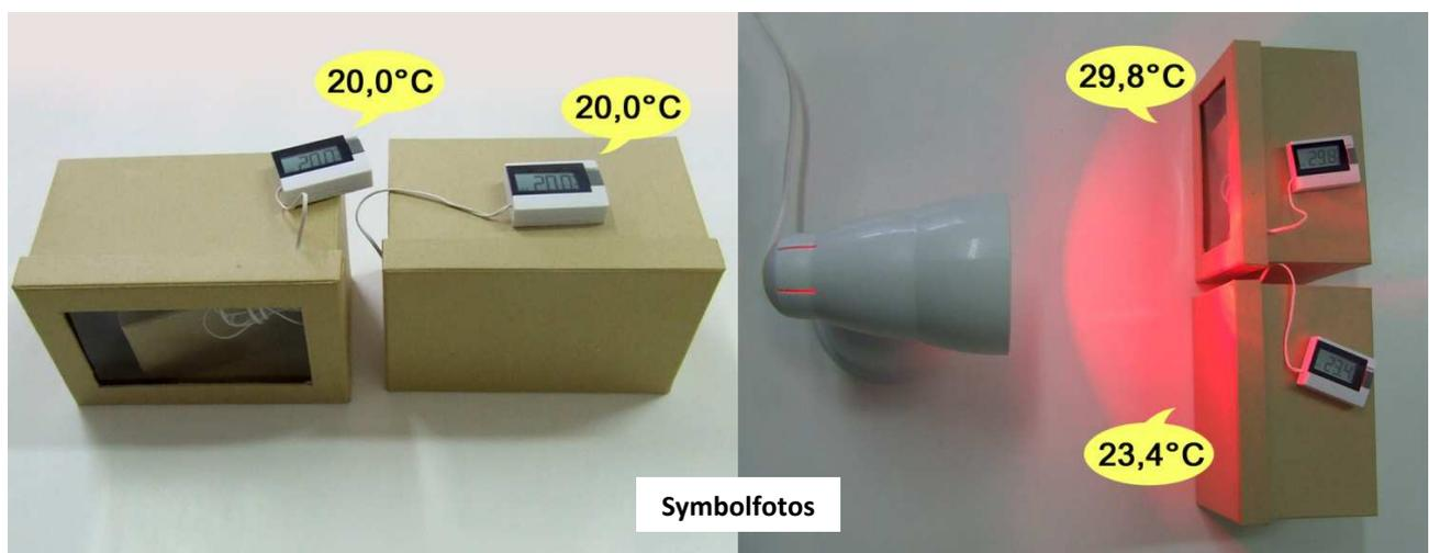
**Alternative:** Die Temperatur kann auch mit dem USB-Temperatur-Logger gemessen werden. Nach einer Zeit von 1-2 Stunden werden die Daten ausgelesen und die Messwerte verglichen.
