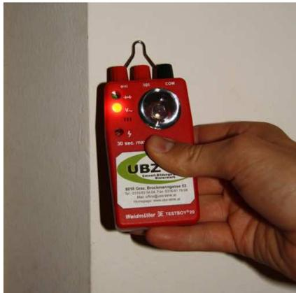
3. Mit dem Messbügel (auf der Rückseite des Testboys) versuchen die Schüler/Innen, (spannungsführende) Leitungen in der Klasse aufzuspüren bzw. zu überprüfen, ob Steckdosen oder Schalter spannungsführend sind.
