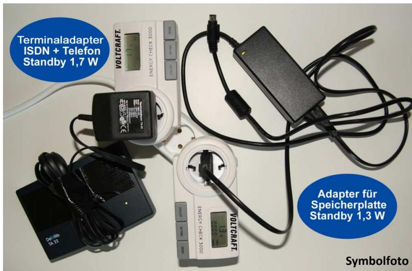
2. Anschließend wird diskutiert, wie lange die Geräte täglich, wöchentlich, monatlich bzw. jährlich in Funktion bzw. auf Standby sind. Dann wird mit den Messwerten der Gesamtverbrauch einiger repräsentativer Schulgeräte berechnet.
