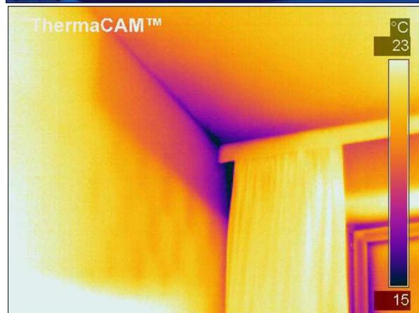
**Innenraummessung:** Kältebrücke in der Ecke zwischen Decke und Außenwand, hier großer Wärmeverlust, außerdem Wärmeverluste durch den Fensterrahmen
