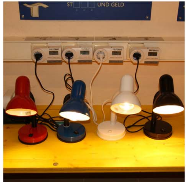
Modell: Stromverbrauch von verschiedenen Leuchtmitteln (Glühlampe, Energiesparlampe, Halogen, LED)
