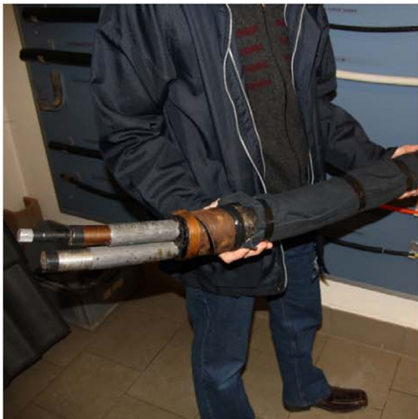
20 kV 3-Bleimantelkabel Gewicht etwa 15 kg/lfm
