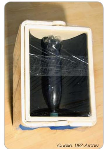
Mit dieser Konstruktion können bereits deutlich höhere Temperaturen als im ersten Versuch erzielt werden. Um dies zu erkennen, ohne allzu lange warten zu müssen, kann bereits 45° C warmes Wasser in die Flaschen eingefüllt werden. Die Temperatur des Wassers wird sich in dem einfachen "Sonnen-Kollektor" tatsächlich noch weiter erhöhen.
