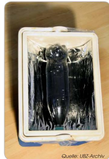
Die Apparatur wird wieder mit der Klarsichtfolie abgedeckt und auf die Sonne ausgerichtet. Die Temperatur wird schneller steigen und einen höheren Wert erreichen als in Teil 2.
