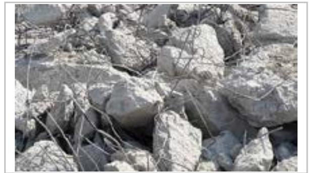
Ansammlung großer Betonbrocken aus denen Baustahlstangen herausragen
