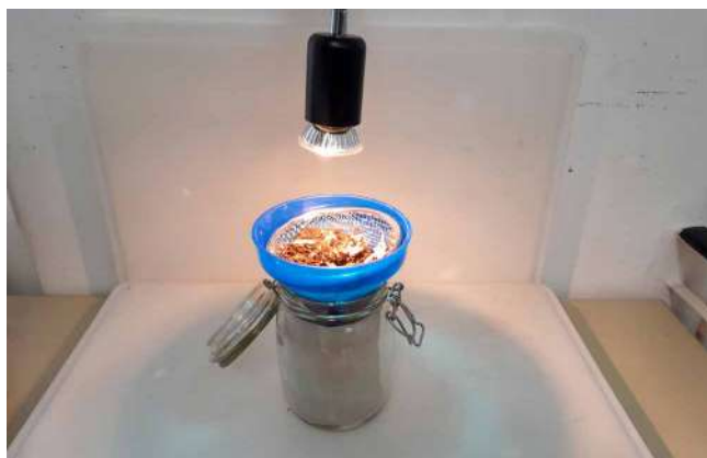
Abb. 3: einfacher Aufbau eines Berleseapparates; UBZ
