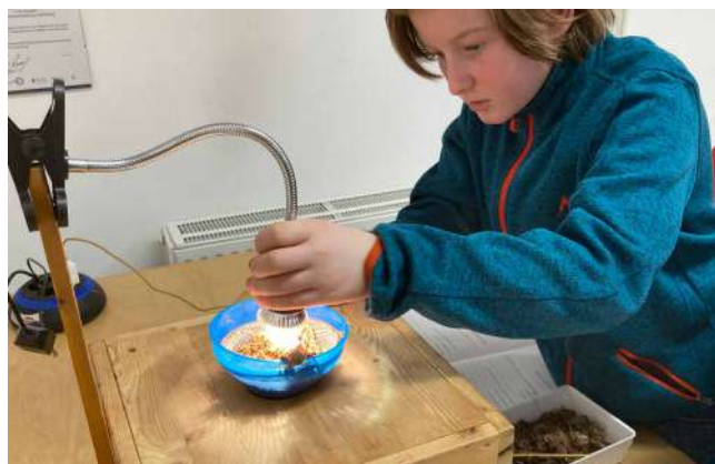
Abb. 3: ausführliche Variante eines Berleseapparates mit Box; UBZ
